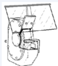
Esmeril con resguardo, portaherramientas y pantalla de protección
