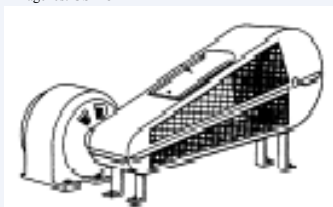
Sistema de polea con resguardo de seguridad
