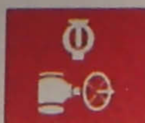
VÁLVULA DE CONTROL PARA ROCIADORES AUTOMÁTICOS
